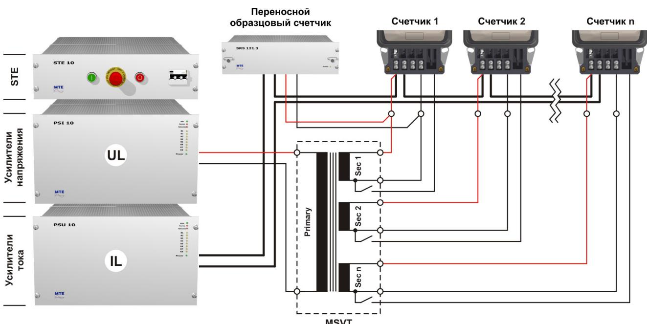
Как у каждого трансформатора напряжения, трансформаторы описанного исполнения предназначены только для одного номинального напряжения. В том случае, когда необходимо поверить на одной поверочной установке однофазные счетчики с различным номинальным напряжением, тогда следует встраивать разные трансформаторы для этих номинальных напряжений.
