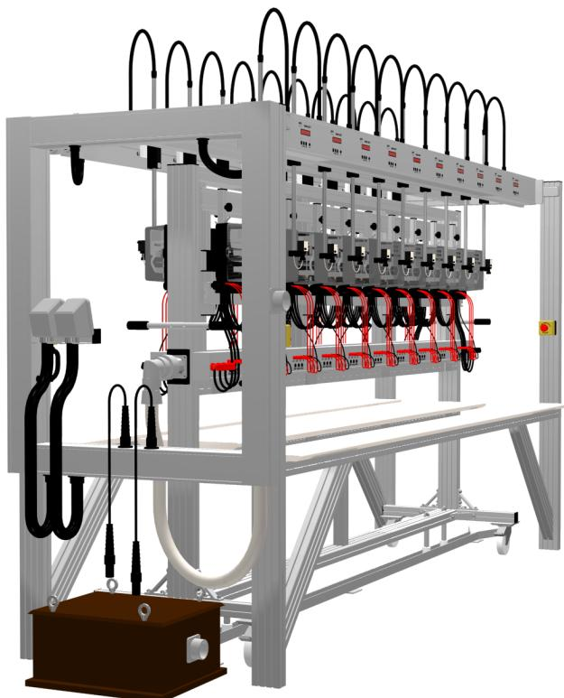
Модернизация состоит в том, что добавляется трансформатор напряжения для необходимого количества испытательных мест и соответственно модифицируется проводка стенда. Поверочная установка в данном примере может дальше применяться обычным образом для поверки традиционных счетчиков. На втором рисунке показано, как подключается к установке новая подкатная рама, которая собрана специально для поверки однофазных счетчиков с не разъединяемыми перемычками.
