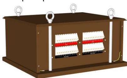
Для уменьшения затрат применяют один многообмоточный трансформатор напряжения с несколькими друг от друга гальванически разделенными вторичными обмотками. Количество вторичных обмоток равно или больше количества включаемых счетчиков плюс одна обмотка для эталонного счетчика. Этот трансформатор изготавливается специально и поверяется в целом. Погрешность, как правило, составляет 0.1 % для каждой вторичной обмотки
