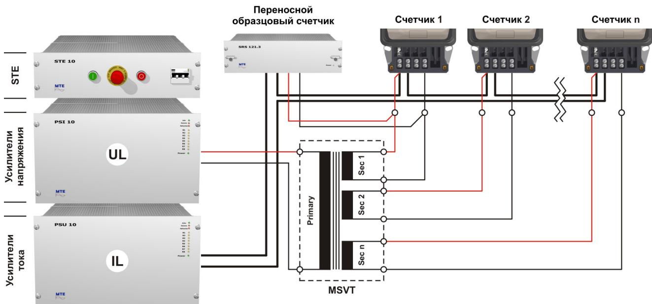
При необходимости поверить многотарифные счетчики, соответствующие напряжения для переключения тарифной катушки также должны быть гальванически разделены. В этом случае трансформатор напряжения должен иметь еще по одному реле с коммутирующим контактом для каждой вторичной обмотки. Исполнение
